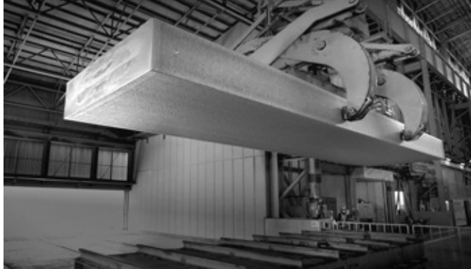
重さ数十tのスラブ（圧延用鑄造原料〔鑄塊〕）。山田氏はこうした巨大な原料や機械に魅了され、入社を決めた
