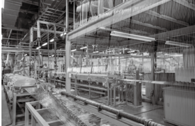
日産1億本の製造ライン。めっき後、線材を直径0.4mmに伸ばし(写真)、接着、曲げ、箱詰めと工程が続く
