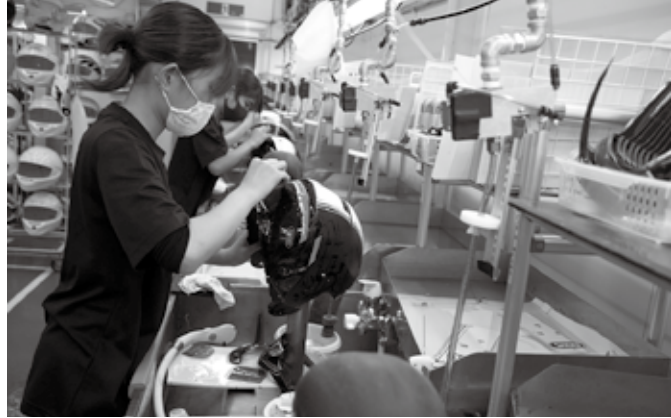
転写シールを使ったカラーリング。サイズが違うヘルメットに同じシールを伸ばして転写する。技術を修得するまでは1年以上かかる
