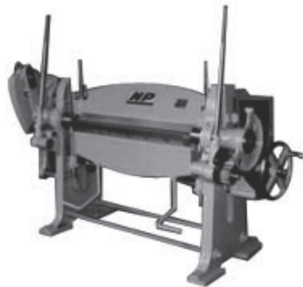
テコの原理を使い手動で曲げ加工が可能な万能折り曲げ機（野口プレス HP より）
