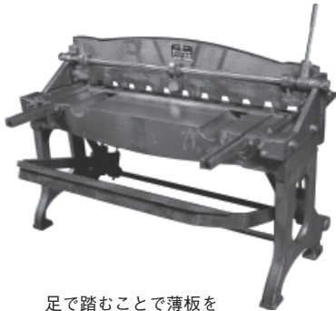
足で踏むことで薄板をせん断する足踏みシャー（盛光 HP より）
