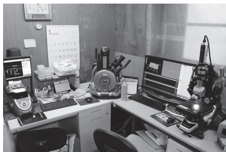
図1 面精度測定も可能なマイクロスコップと高倍率画像寸法測定機
