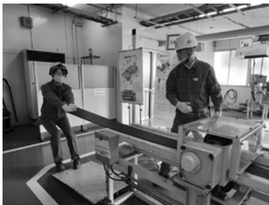
写真2 ゴムベルトを使って巻き込まれの威力やスピードを体感
