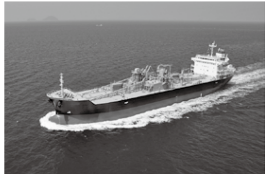
写真3 セメント船荷役設備
