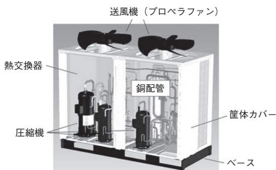
図1 室外機の構造
