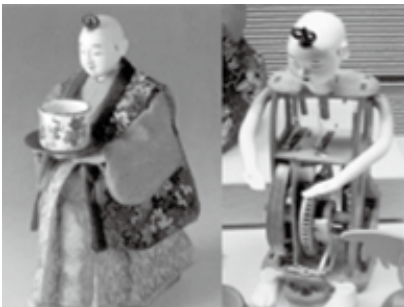
写真1 茶運び人形とその内部構造
