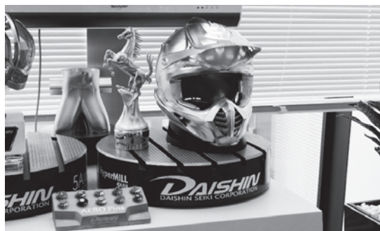
写真1 120 kg のアルミニウムから削り出したモトクロス用の1/1ヘルメット(右)や自由曲面の高品位加工を示すサンプル
