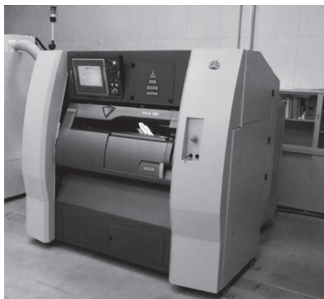
図1 都産技研の3次元金属積層造形機「ProX300」（3D Systems社製）
