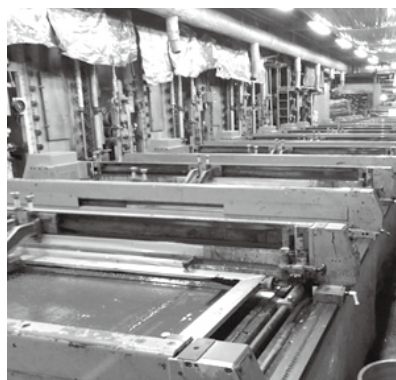
写真1 フラットスクリーン設備
