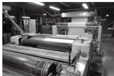
写真2 ロータリースクリーン設備
