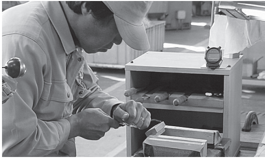
写真1 0.001mmを削るきざげ作業には暗黙知が多い
