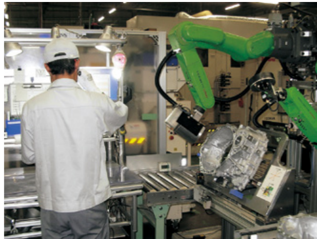
自動車部品の検査工程で稼働する協働ロボット
