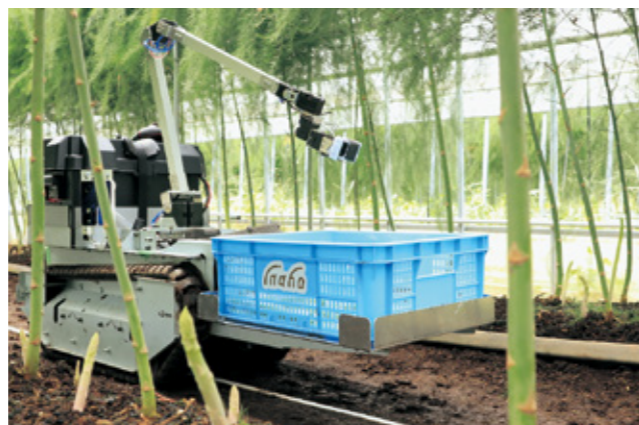
アームにより1台で複数種類の野菜を収穫できる汎用型のロボット。製造コストを抑えることで原価を早期に回収できる
