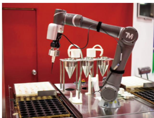
たこ焼きロボット「OctoChef」。工程によりタコピックなど4種類のツールを使い分ける
