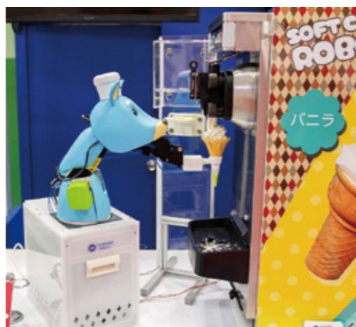
ソフトクリームロボット「レイタ」。ハンド部分に重量センサーを備え、一定量の抽出が可能
