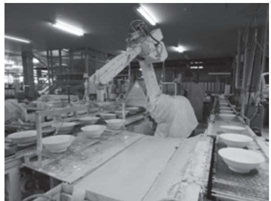
写真4 釉薬をつける工程はロボットで自動化
