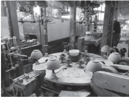
写真2 全自動成形機での仕上げ工程
