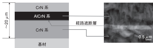
図 1 Tribec SC の皮膜構造
