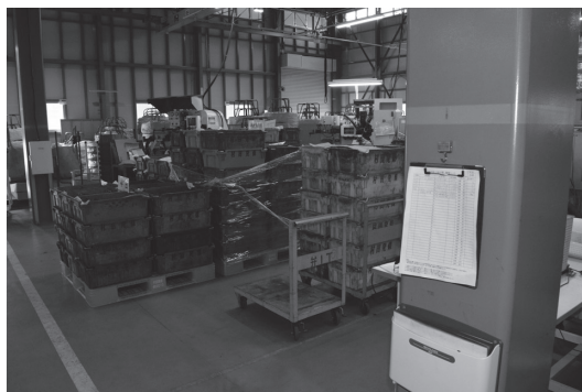
写真3 地上高150cmに印。積み上げ高さを制限してきれいな見た目と安全性を維持
