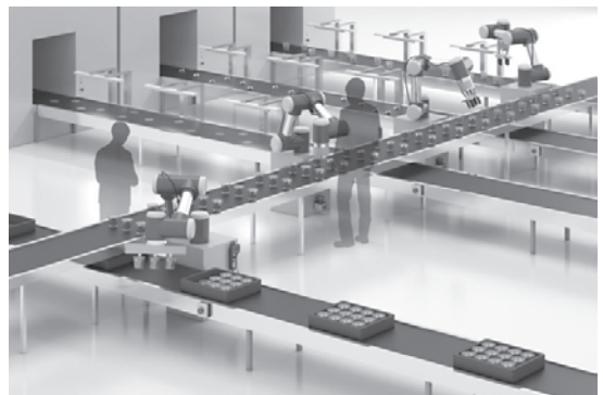
図1 協働ロボットを用いた人-ロボット協調生産ラインのイメージ
