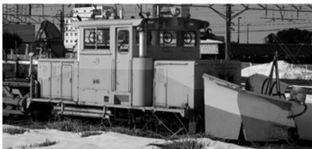
図A 除雪装置を取付けたモーターカの例
