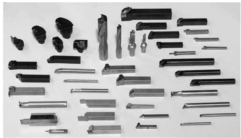
図1.1 いろいろなスローアウェイ切削工具(出典:日刊工業新聞社 DVD教材「旋盤加工」)
