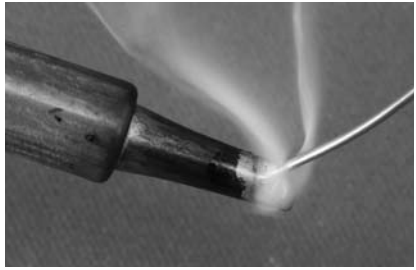
図1.4 煙となって蒸発するフラックス（※この写真は作業者の正面から撮影しています）
