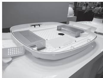
写真6 3Dプリンターで製造したAI Pilotの筐体
