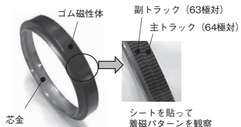
図1 複列磁気エンコーダ(着磁リング)外観
