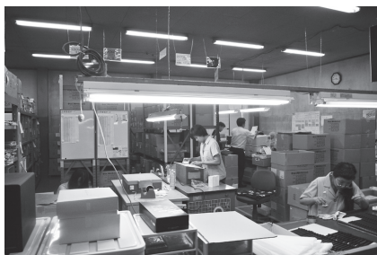
在庫の山を整理し、検査員の作業場とその後ろに成形機ごとのストアを設置
