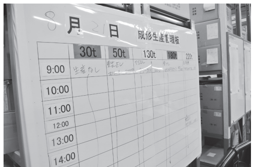
生産管理板で、作り過ぎている成形機に見える化。“生産なし”の状況にも慣れてきた
