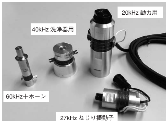
写真1 各種超音波振動子
