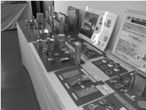
展示室に陳列されたインパクト成形サンプルの数々。写真左奥が矩形形状品。インパクト成形は材料のスラグ形状と金型を同時に設計する必要があり、板厚を任意に設定できる点が特徴
