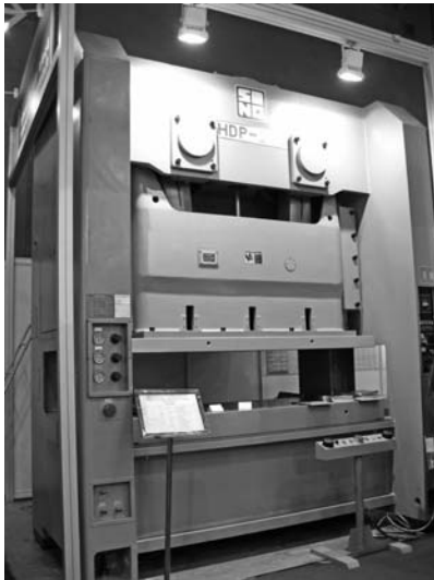
写真 14 200 tのクランクプレス
