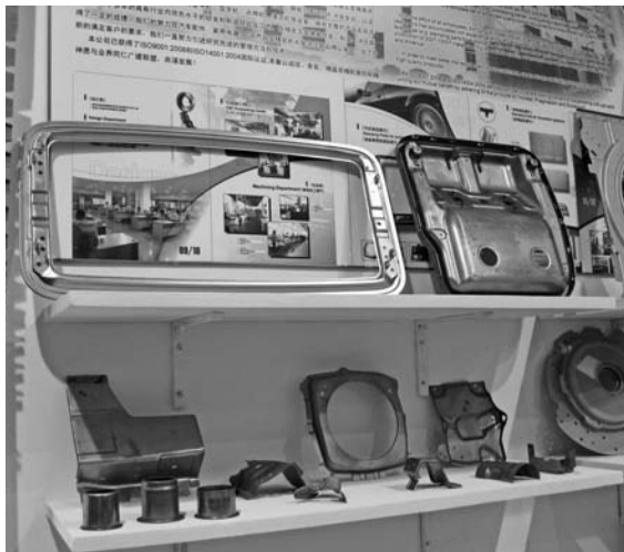
写真 8 自動車のサンルーフなどの プレス成形品
