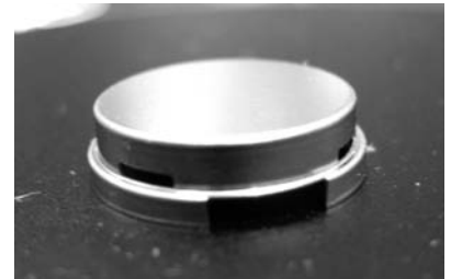
絞りと曲げの複合加工の成形品。絞り加工後にカムを使って横から穴あけ加工する。材質はステンレス、板厚 0.15 mm。 (株)ゼロム ( http://www.xerom.jp/ )
