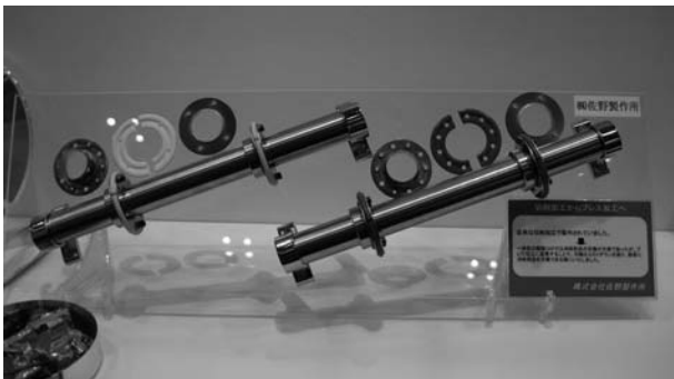
顧客の課題解決に取り組み、切削からプレス加工に転換。切削による一体型の駆動コロより消耗部品の交換が容易になっただけでなく、大幅なコストダウンに成功した。 (株)佐野製作所 ( http://www.sano-ss.jp )
