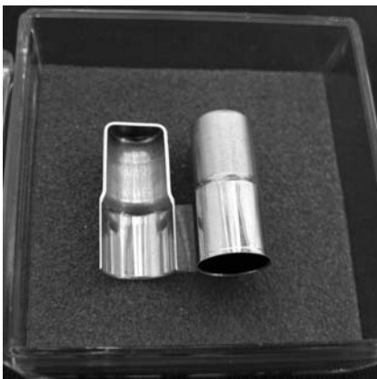
インコネル材を板厚 0.5 mm → 0.25 mm の半分の板厚に減肉加工した。インコネル材は他の材質に比べて粘着性が強いいため、深絞り加工は難しい。増肉加工も対応可能。 (株)加藤製作所 ( http://www.ksj-group.com/ )
