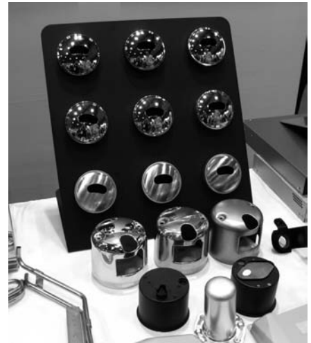
絞り加工によるバイク車載部品を展示した。110 t の油圧絞り用プレスで絞り加工した後に穴あけし、穴の回りをバーリングでつぶしている。材質 SPCE、板厚 0.8 mm。 (株)藤田製作所 ( http://www.fu-ji-ta.co.jp )
