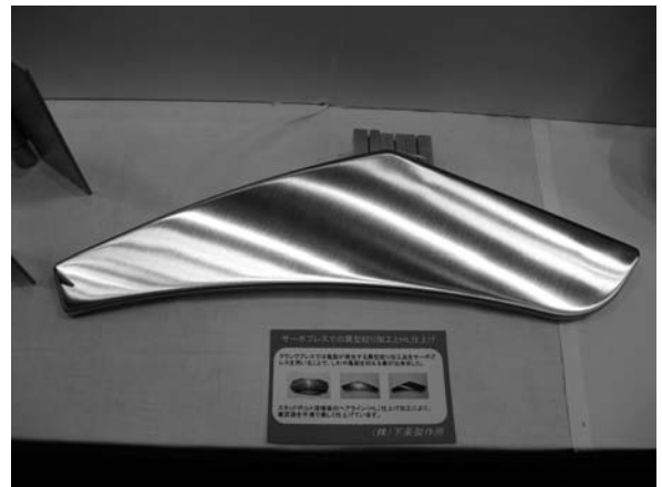
サーボプレスを使った異形絞り加工。一般プレスではしわや亀裂が発生していたが、サーボプレスの可変モーションによって解消された。材質 SUS 304、板厚 1.0 mm。 (株)下条製作所 ( http://www.fsinet.or.jp/~kamotetu/MEMBER/gejyo.htm )
