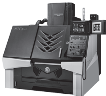
写真1 油静圧案内の超精密微細加工機 Genesis
