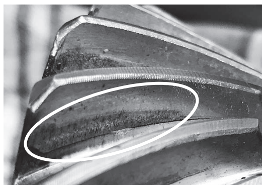
図3 歯面のスカuffィング、スカuffィングによって折損した歯
