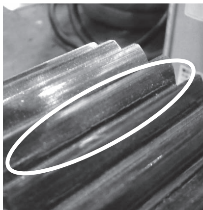
図1 磁粉探傷検査によって発見された歯元の割れ
