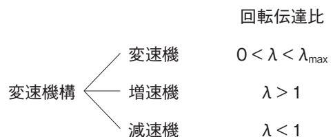
図2 回転伝達比の値による機構の分類
