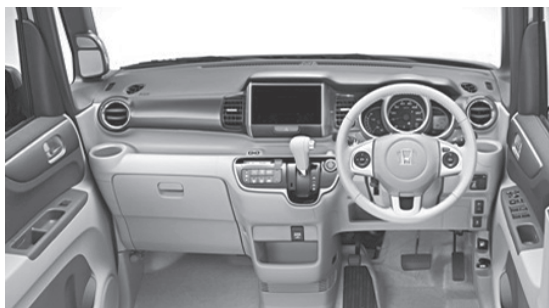
図1 マスキング塗装による2色インパネ(旧型N-BOX)
