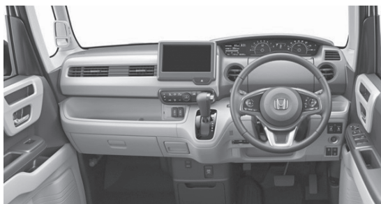
図2 一体成形による2色インパネ(新型N-BOX)
