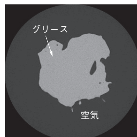
図1 X線CTを用いて撮影したテストグリースの断層像
