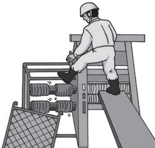
図1 圧延機の調整作業中の事故
