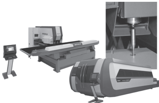
写真1 タレットパンチプレスとファイバーレーザー加工機による複合加工
