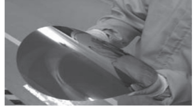
Si ウエハでは 30μm 厚まで薄膜化可能
