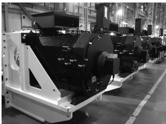
写真1 自社開発の大型サーボモータ (750 kW)
