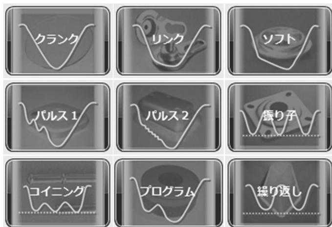
図1 サーボプレスにおけるスライドモーションの例
