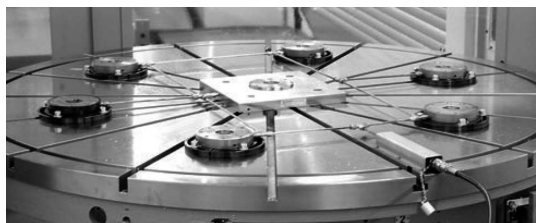
図1 マシンテーブル上に取り付けられたゼロポイント・クランピング・システム
