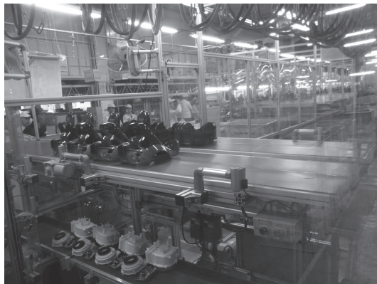
写真2 掃除機組立ライン セルへの部品自動供給システム
