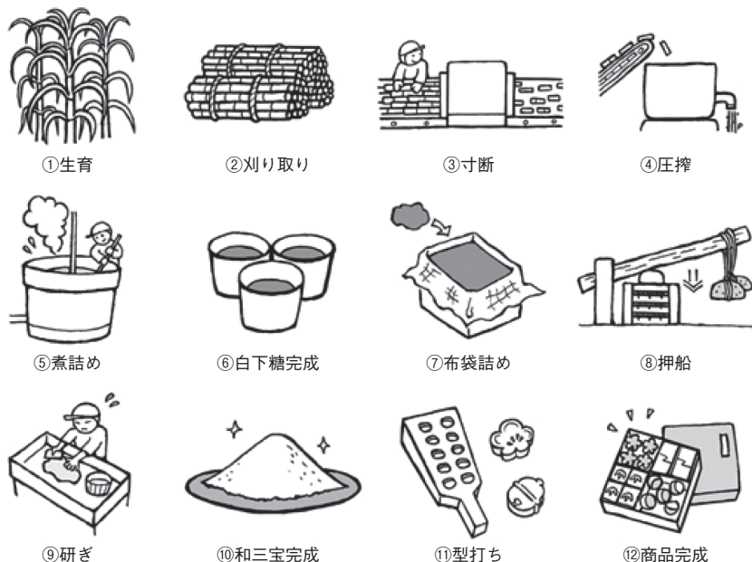
図1 和三宝と御干菓子の製造の流れ
