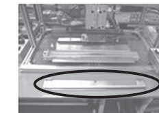
治具を2セット準備し交互に溶解作業を実施。
