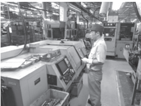
写真1 機械の番人になっていないか(手持ちのムダ)
