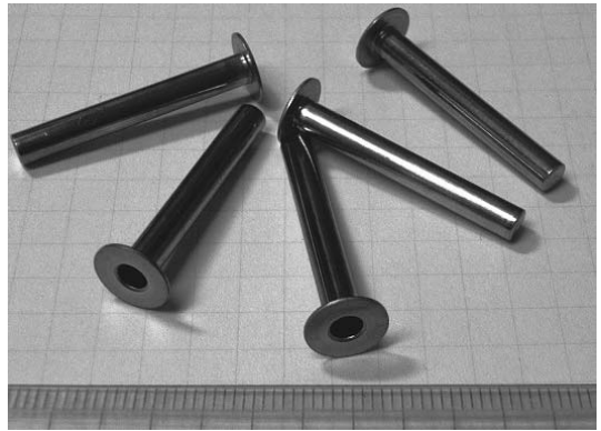
写真1 高精度絞り加工品 (株共伸) 材質 C 2680、真直度、真円度とも 5\mu\text{m} 以下
