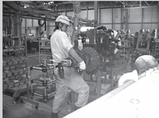
写真2 エンジン/トランスミッション結合作業(サブライン)
