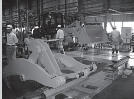
写真4 手前はフロントアーム(リフトアーム)組立サブライン、後方は建機本体のメインライン
