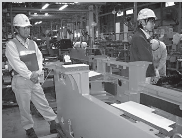
写真5 リアフレーム組立作業(サブライン)
