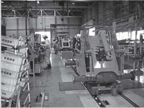
写真3 建機本体の組立/フロントアーム取付け(メインライン)
