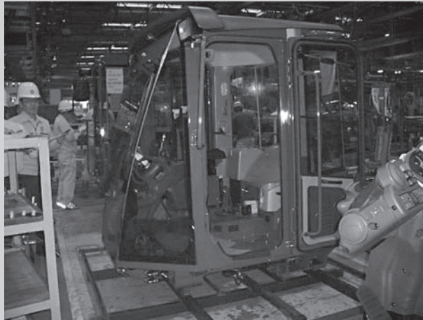
写真4 キャブの艤装作業
