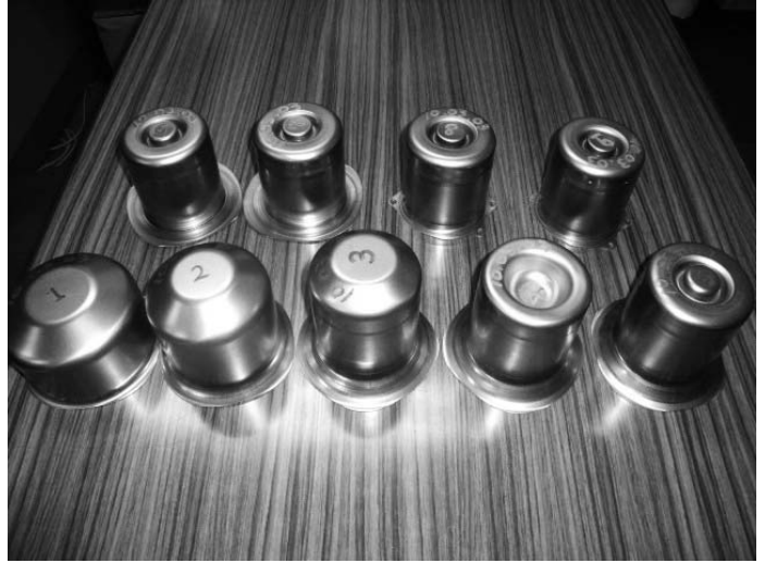
写真 1 SPFC 440（板厚：0.8 mm）で モーターブラケットを試作した 際の工程サンプル
