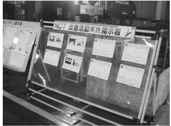
写真2 高さを制限するとともに、板を透明にすることで、さらなる見える化
