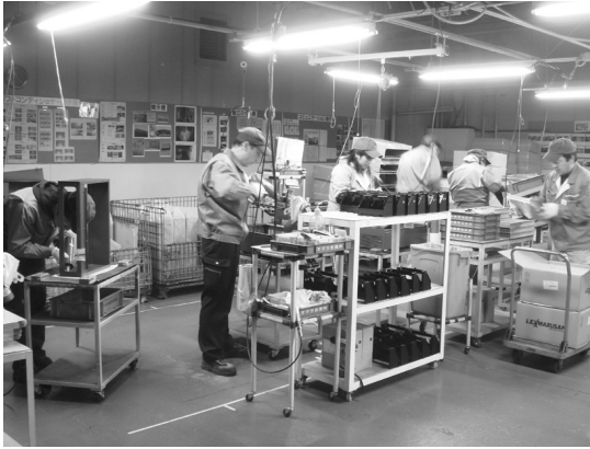
写真1 パワーコンディショナーの組立てラインも田の字化。また、照明の高さを低くして照明の数を減らし、エネルギーコストの削減にもなっている
